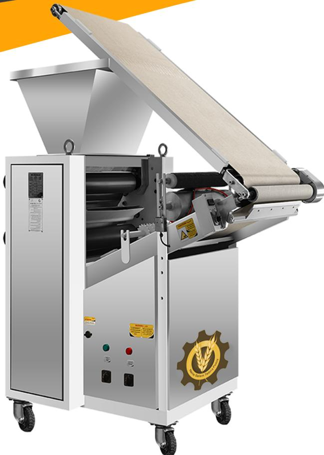
دستگاه پهن کن برای نازک کردن خمیر مورد استفاده قرار می گیرد . وقتی این دستگاه در کنار دستگاه نیمه اتومات دوار قرار میگیرد نانوا خمیر را پس از انکه به صورت اتومات برش خورد و رو بالشتک قرار گرفت با دست به بستر پخت انتقال می دهد و زمانی که پهن کن در ابتدای دستگاه تولی اتومات قرار گیرد . خمیر به صورت ات به بستر منتقل می شود . در این دستگاه ضخامت خمیر تنظیم می باشد و سرعت عملکرد آن نیز با استفاده از اینورتر قابل کنترل می باشد
