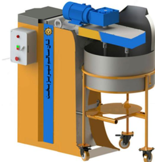
۲- میکسر خمیر نان سنگ ک با سرعت بالا و تغار جدا شونده(دارای تغار و پایه مخصوص جهت انتقال خمیر به بالابر و خمیر پهن کن) با ظرفیت تولید ۱۰۰ کیلو گرم خمیر نان سنگ در هر سیکل کاری
